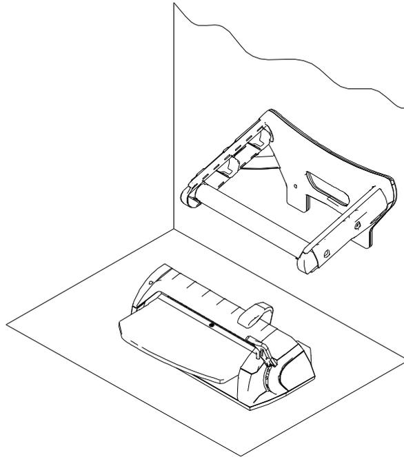
Na configuração com porta-rolos na parede, só o corpo da máquina possui uma dimensão total de 330 mm, porque estão montadas as guias de aço.
