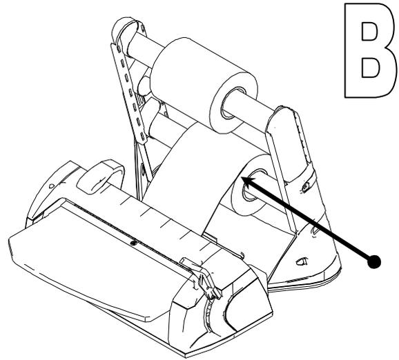
4) Extraia o papel com o comprimento desejado e abaixe a alavanca de soldadura. O led luminoso torna-se verde a piscar durante a fase de soldadura (por 3 segundos).
