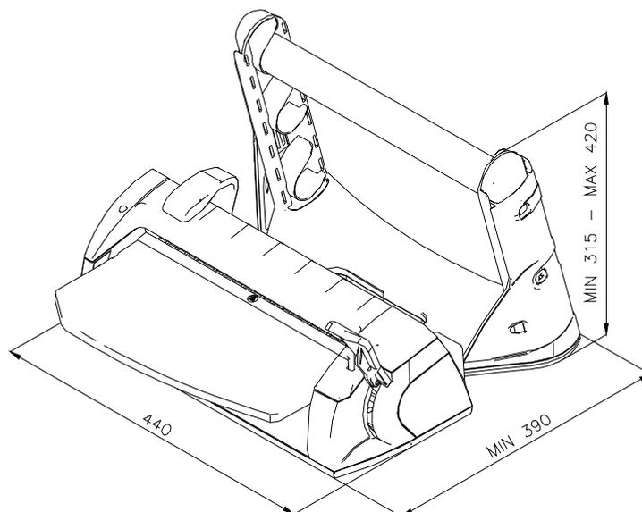
Dimensões máximas da termoseladora
