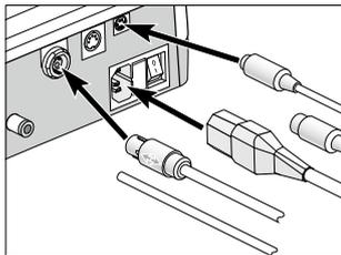
**1** Conecte el cable del motor, el elemento de mando (opcional), el tubo flexible de aire (Perfecta 600) y el cable de red.
