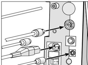
**2** Conecte el cable del motor, el elemento de mando, el tubo flexible de aire (Perfecta 600), el pedal (opcional) y el cable de red.
