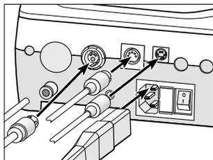
**1** Conecte el cable del motor, el elemento de mando, el pedal, el tubo flexible de aire [Perfecta 600] y el cable de red. Preste especial atención a la posición.
