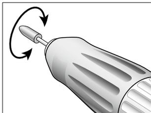
**2** Ponga en funcionamiento la pieza de mano con motor hasta que se haya alcanzado el número de revoluciones necesario. Transcurridos unos 2 segundos, suena una señal acústica y el número de revoluciones queda almacenado.
