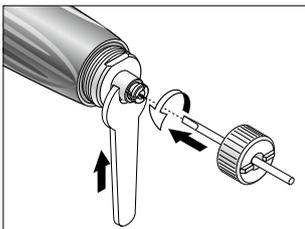
❷ Introduzca la llave para pinza de sujeción hasta que encaje en la pinza de sujeción y desenrósuela girándola hacia la izquierda.
