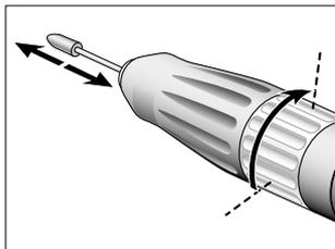
① Gire hacia la derecha el anillo tensor hasta llegar al tope. Introduzca o extraiga la herramienta rotatoria hasta que llegue a su tope.
