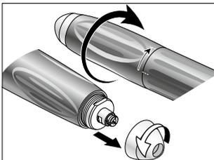
❶ Gire hacia la derecha la cubierta delantera del mango hasta llegar al tope. Desenrosque la punta girándola hacia la izquierda.
