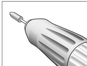
**3** Detenga la pieza de mano con motor pulsando el pedal o la tapa.
