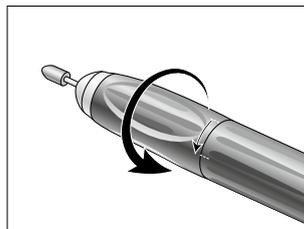
② Gire hacia la izquierda la cubierta del mango delantera hasta oír que encaja.
