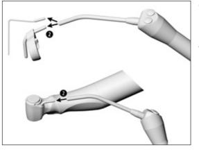
② 圧縮空気を使用して、注水チューブと注水ノ ズルの中にエアーを吹き付けます。
