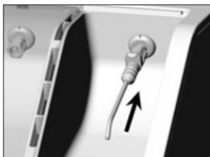
❷ Conecte el adaptador con el orificio de salida hacia abajo.
