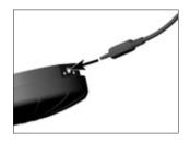
Ф Вставьте зарядный кабель в разъем для зарядки на блоке ножного управления.
