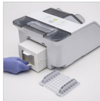
**Набор Twin Care Set** состоит из одного картриджа очищающего раствора, одного картриджа масла Service Oil F1 и HEPA-фильтра. Все расходные материалы легко и просто заменяются без использования инструментов.
