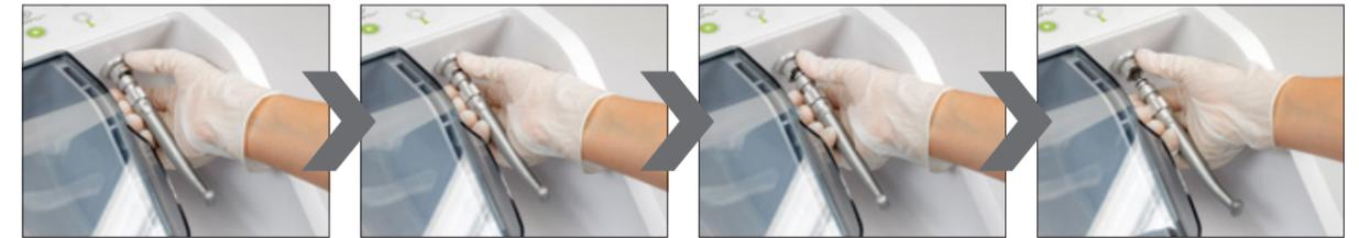
› Entnehmen Sie die Turbinen-Adapter-Verbindung vom Pflegeansatz der Assistina Twin
