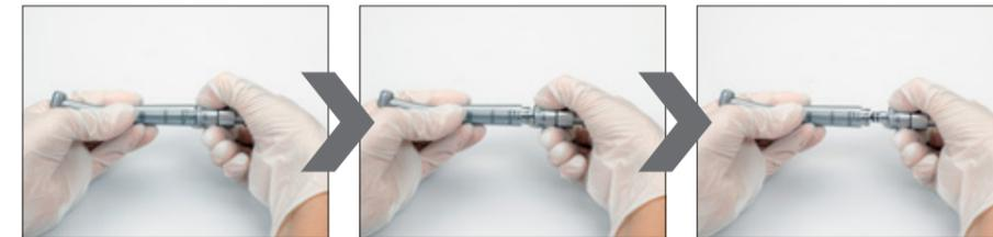
› Trennen Sie die Turbine vom W&H Roto Quick-Adapter
